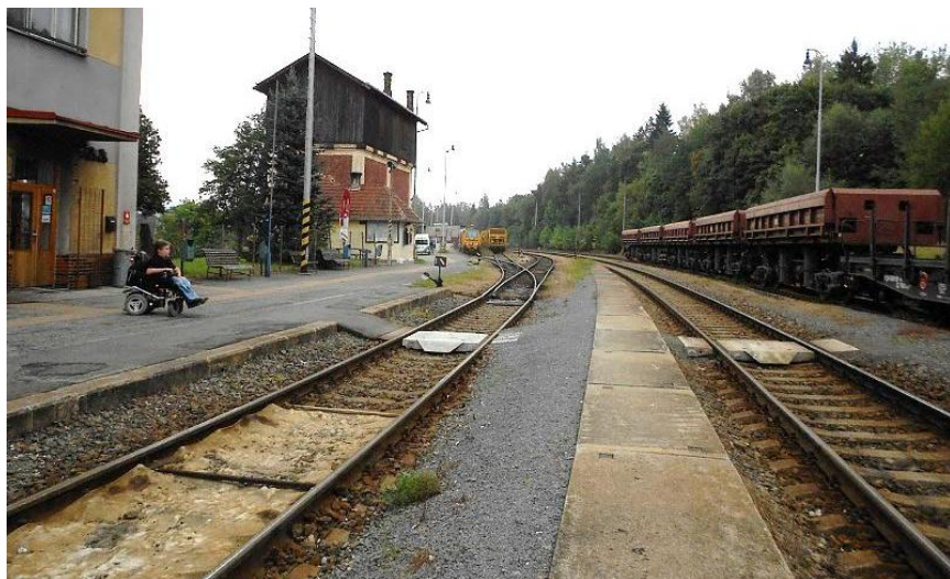
Železniční stanice Plasy – romantika pražců a kolejí – pro vozíčkáře bohužel zkalená neromanticky nízkým nástupištěm, jehož hrana má v ideálním případě být vysoká 550mm, což zde očividně není
