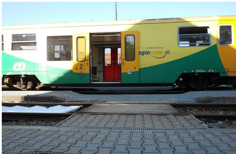
Železniční stanice Třemošná s nízkopodlažním vozem Regionova u nástupiště – názorně je vidět, jak velký výškový rozdíl (a jak velký sklon) by vozíčkář musel překonat po nájezdové rampě, která je v těchto vozech součástí vybavení
